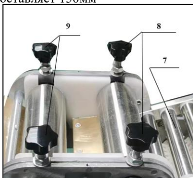
Рис2. Регулировка, предварительная раскатка теста
