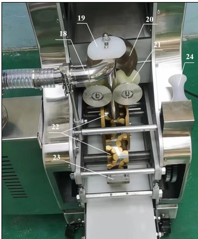
Рис4 Основные элементы узла матрицы
