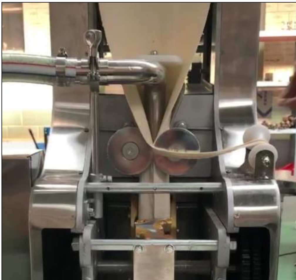
Рис6. Формирование тестовой трубы и подача к матрице
